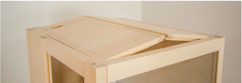
Fig. 15: Fissaggio degli elementi tetto
