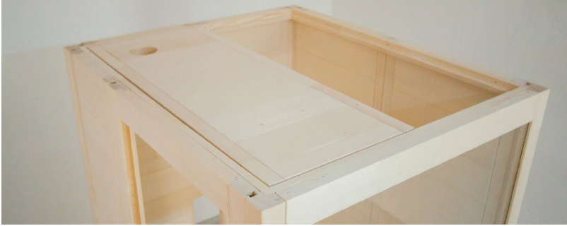
Fig. 14: Inserimento dell'elemento tetto anteriore
